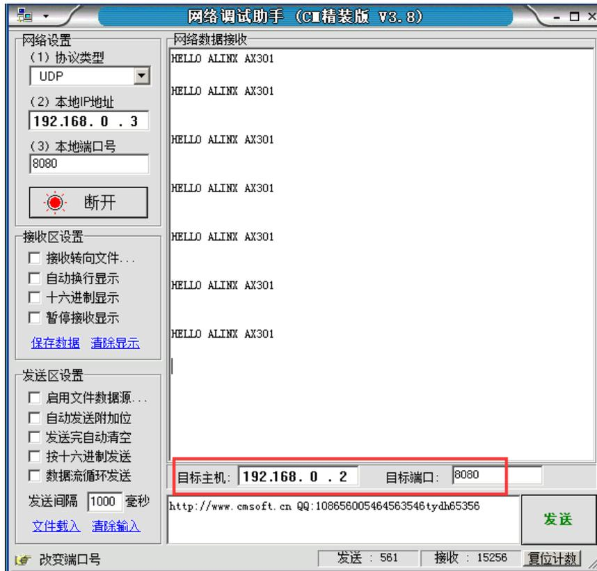
第三步：再在网络调试助手的发送窗口发送一大串字符,在网路的数据接收窗口我们可以看到从 FPGA 返回的数据也变成刚发送字符串。
