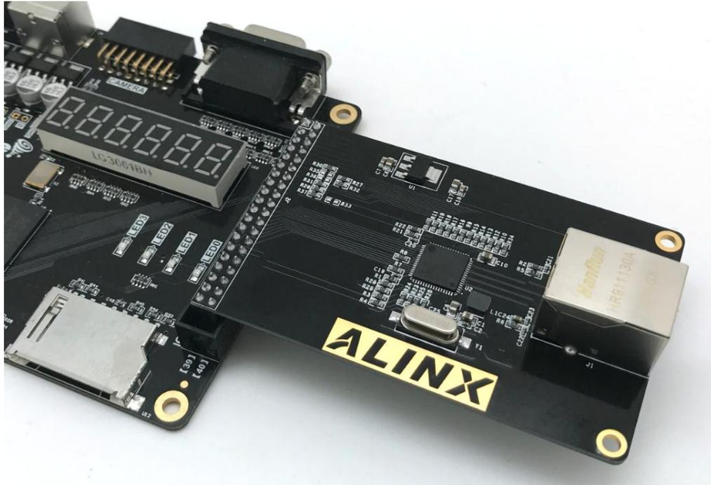
开发板上电，以太网模块的网口和电脑的网口用千兆网线(5类加或者6类线)连接。接下去我们就可以开始做以太网的实验了。
