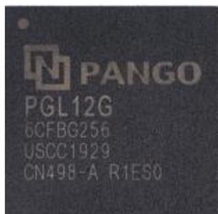
图 2-2-1 FPGA 芯片实物
