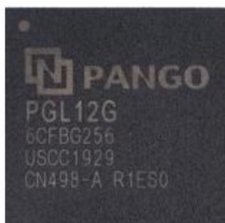
图 2-2-1 FPGA 芯片实物
